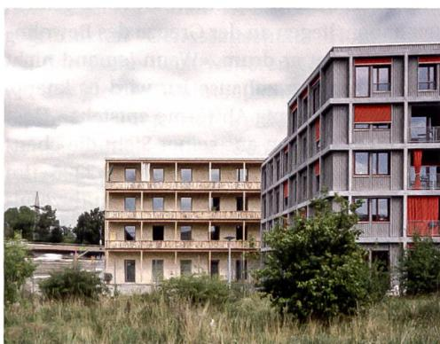
Das Konzept des heizungsfreien Wohnatelierhauses (auf dem kleinen Bild links) basiert auf dicken Mauern und einem reduzierten Fensteranteil. Die Wärme liefern Sonneneinstrahlung, Elektrogeräte, Lichtinstallationen und Menschen.
