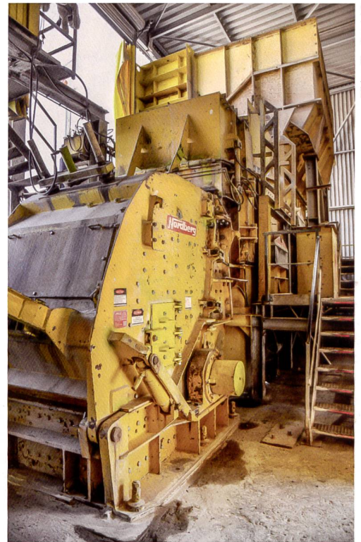
Der Misch- und Betonabbruch vom Brüderhofweg wurde im Baustoff-Recycling-Zentrum «Ebirec» in Rümlang (ZH) aufbereitet, in der Mitte die Brecher-, ganz rechts die Betonmischanlage.
