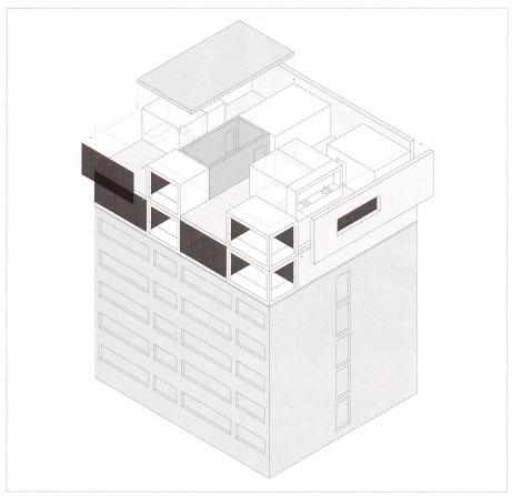
«Living Shell» ist ein Leichtbausystem, das für die Erweiterung und Aufstockung bestehender Bauten entwickelt wurde.
