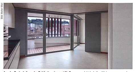
Aus der Dreiecksform der Gebäude – sie sorgt für Panoramasicht bei allen Wohnungen – ergab sich eine Abfolge von aneinandergekoppelten Räumen, zu denen auch der offene Küchen- und Essbereich zählt. Der Boden besteht aus aufs Korn geschliffenem versiegeltem Anhydrit (Mieter-Baugenossenschaft Wädenswil, Siedlung Neudorf, Wädenswil, 2017; Architektur: Esch Sintzel GmbH Architekten ETH BSA, Zürich).
