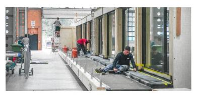
Vorgefertigt von der Photovoltaikanlage bis zum Parkett: Blick in die Produktion der Zimmermodule im Werk der Häring AG in Eiken.
