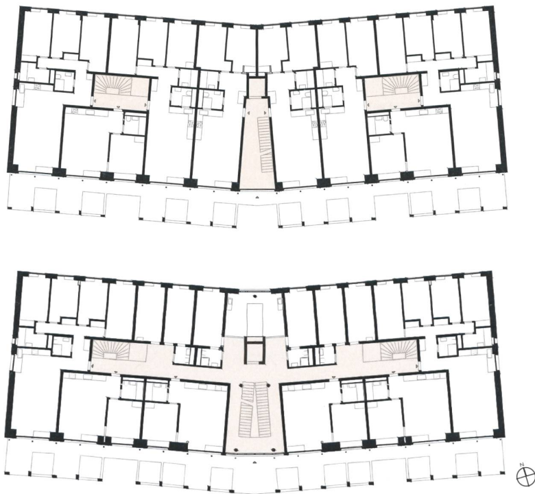
Grundrisse des Regelgeschosses (oben, 1. OG) und des dritten Geschosses. In der Gebäudemitte befindet sich der einzige Lift. Das dritte Geschoss besitzt als einziges eine «rue intérieure», dank der alle Wohnungen direkten Liftzugang haben. Dort ist unter anderem die Waschküche untergebracht.
