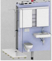
Die Firma Swissframe hat das Vorwandsystem so weiterentwickelt, dass es gleich die Warmwasseraufbereitung umfasst. Eine kleine Wärmepumpe nutzt die Abluft der Wohnungen, um einen Hundert-Liter-Boiler aufzuheizen.
