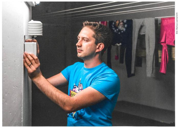
Klein und billig: Mit einfachen Sensoren lassen sich ganz unterschiedliche Messdaten, etwa zu Luftfeuchtigkeit oder -qualität, über Funknetzwerke mit grosser Reichweite übermitteln. LoRaWAN machts möglich.
