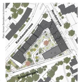
Die Kronenwiese liegt nahe der Limmat zwischen der stark befahrenen Kornhausstrasse und dem Schindlerpark. Die Überbauung trägt dem Rechnung mit einer Blockrandbebauung, die sich gegen den ruhigen Grünraum hin öffnet.
