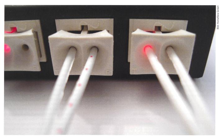
Wenn Mieter moderne TV-Angebote und Home-Office nutzen, benötigen sie rasch mehr Kapazität für den Datenverkehr. Eine kostengünstige Möglichkeit dazu bieten Lichtwellenleiter. Solche Polymerfasern eignen sich für Neubau und Sanierung, lassen sie sich doch gleichzeitig mit der Elektroverkabelung einziehen.
