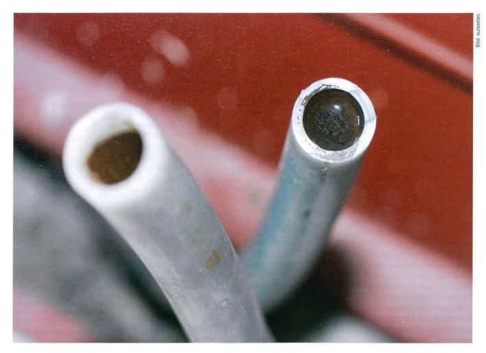
Ablagerungen in Leitungen von Fussbodenheizungen vermindern mit der Zeit die Heizleistung.
