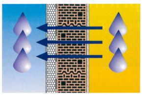
Bis 10 Liter Wasserdampf müssen pro Haushalt und Tag nach aussen dringen. Die Baumit Open-Klimafassade leistet dazu einen wichtigen Beitrag, denn die Fassadenplatte «open Therm» Duo hat den gleichen Diffusionswiderstand wie eine Ziegelwand.
