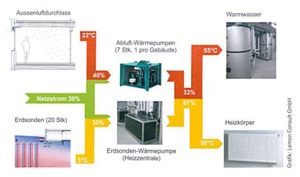
Das neue Energiekonzept setzt sich zusammen aus Abluft- und Erdsonden-Wärmepumpen. In den Wohnungen wird weiterhin über die bestehenden Radiatoren geheizt.
