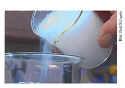
Aerogel-Dämmputze bieten schon bei vier Zentimetern Dicke eine sehr gute Isolation. Das Nanomaterial besteht zu fünf Prozent aus Silikat, der Rest ist Luft.
