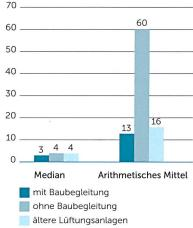
Messungen der Feinstaubkonzentration in der Zuluft von Lüftungsanlagen in 38 Gebäuden.
