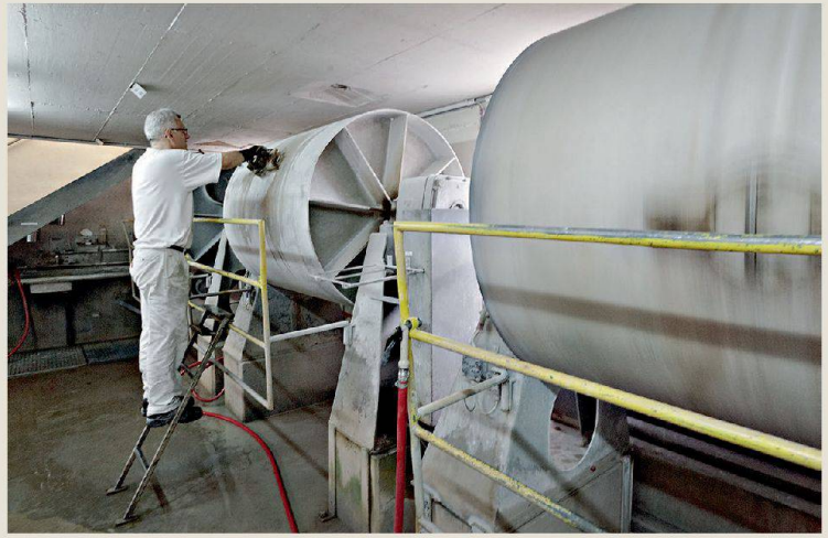
Herstellung von Email: Das Zermahlen von Fritte (Glassplittern), Ton und Wasser zu dickflüssigem Schlicker dauert fünf Stunden.
