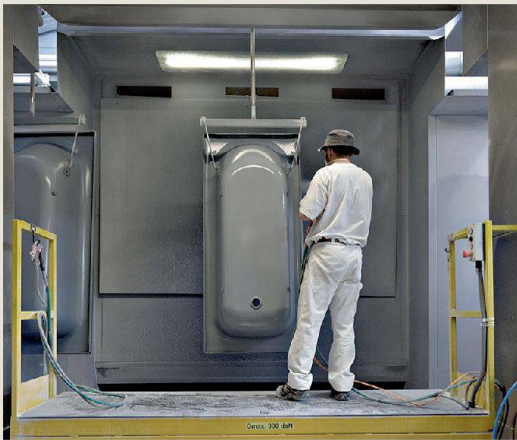
Farbiges Email wird von Mitarbeitern, weisses in automatisierten Anlagen von Robotern auf die Wannen gesprüht.
