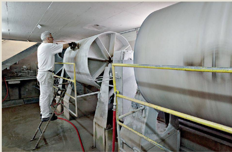
Herstellung von Email: Das Zermahlen von Fritte (Glassplittern), Ton und Wasser zu dickflüssigem Schlicker dauert fünf Stunden.
