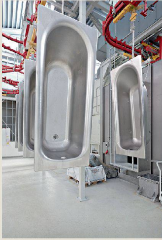
Rohwannentransport. Nach dem Entfetten bringt eine Förderanlage die Wannen zum Emaillieren.
