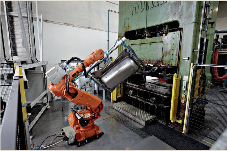
In der Tiefziehpresse verwandelt sich eine Platte titanlegierter Stahl durch Druck in kurzer Zeit in eine Rohwanne.
