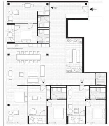
Grundriss einer Grosswohnung der Genossenschaft CoDHA für drei Haushalte mit drei Suiten, grossem Gemeinschaftsbereich und Gästezimmer.
