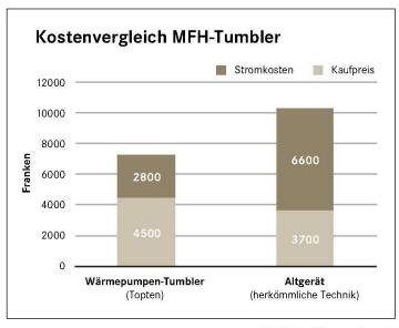
Jährlicher Stromverbrauch eines Tumblers im Mehrfamilienhaus. Links modernes Wärmepumpengerät, rechts Altgerät Klasse B.
