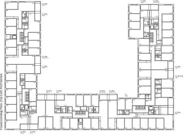
Zita Cotti Architekten entwarfen für das Baufeld B4 Süd vielfältige Grundrisse (Regelgrundriss OG).
