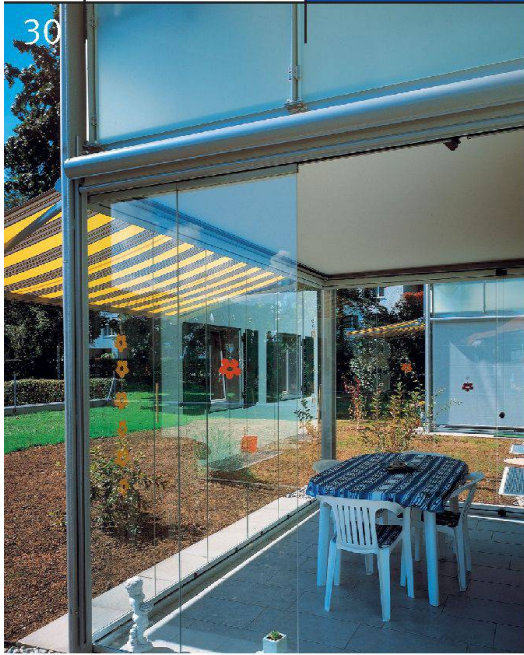
Wintergärten sind rundum geschlossen und mit wärmedämmten Fensterprofilen und Wärmeschutzglas ausgestattet.
