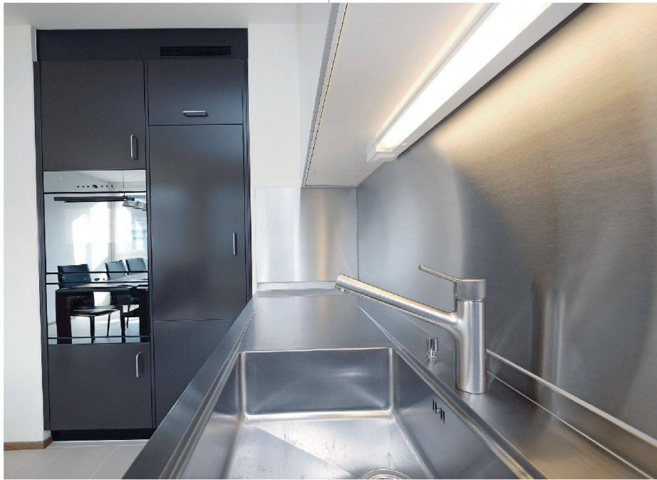
Die durchgehende Chromstahlabdeckung wurde von Suter Inox eigens für die Küchen in der Siedlung Klee angefertigt.
