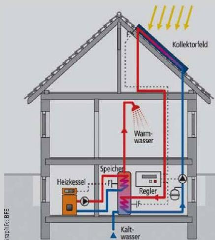
Die von den Sonnenkollektoren gelieferte Wärme wird an einen Wasserspeicher abgegeben und zur Erwärmung des Warmwassers verwendet.
