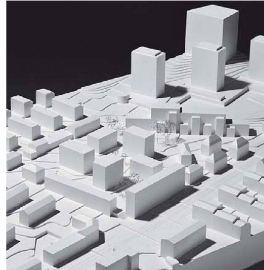
150 Wohnungen erstellt die Baugenossenschaft Rotach beim Zürcher Triemli. Das Büro Hauenstein La Roche Schedler entwarf zwei lange Zeilen, die die dahinterliegenden fünf Hofhäuser vom Verkehrslärm der Birmensdorfer- und der Schweighofstrasse abschirmen. Im Hintergrund die Hochhäuser des Triemli-Spitals.
