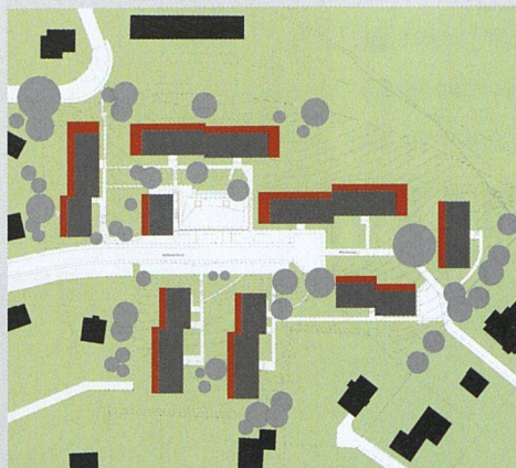
Die Bauten sind locker am Hang angeordnet, rot eingezeichnet die angebauten Teile.
