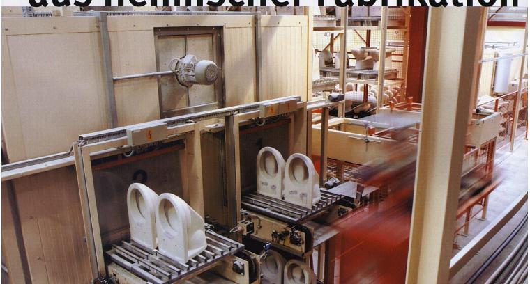
Die Herstellung von Sanitärkeramik ist ein mehrstufiger Prozess, der trotz Automatisierung und moderner Technik immer wieder Handarbeit erfordert. Im Bild WC-Rohlinge auf dem Weg zum Trockner.
