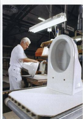
Stufen im Produktionsprozess: Giessen, Brennen, Qualitätskontrolle.
