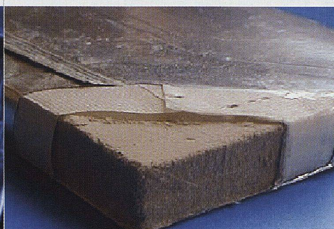
Vakuumdämmplatten (VIPs) bestehen aus einem Füllmaterial aus Kieselsäure. Sie leisten schon bei geringer Stärke eine ausgezeichnete Dämmwirkung.
