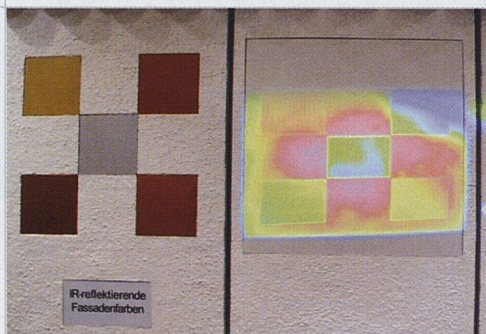
Thermografie einer Fassadenbeschichtung mit Infrarotreflektierenden Pigmenten.
