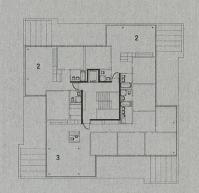
Grundrisse Norm-Obergeschoss (links) und Dachgeschoss (rechts).  $1 = 4\frac{1}{2}$  Zimmer,  $2 = 3\frac{1}{2}$  Zimmer,  $3 = 6\frac{1}{2}$  Zimmer
