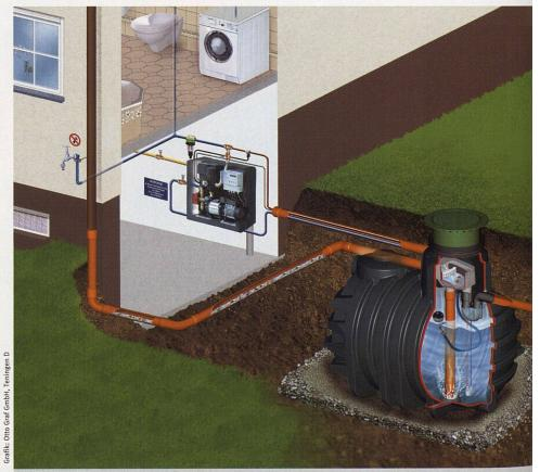
So funktioniert ein moderner Regenwassertank: Diese Anlage für die Garten- und Hausnutzung verfügt über ein so genanntes Not-Nachspeisemodul. Sollte der Tank zu wenig Wasser haben, tritt es automatisch in Aktion. Neu ist, dass hier
