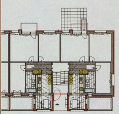
Grundriss zweier rundum erneuerter Wohnungen in Haus B. Rot eingezeichnet der neu angebaute Essplatz sowie der neue Balkon.
