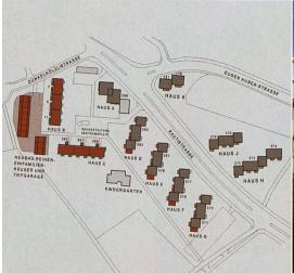
Übersicht über die Siedlung Thalbächli mit insgesamt 176 Wohnungen. Die Bauten der ersten Sanierungsetappe (A, K, J, H) erhielten eine Innenrenovation und neue Balkone, das Hochhaus (A) eine neue Fassadenverkleidung. In der zweiten Etappe (B, C) nahm man zusätzlich Aufstockungen und Erkeranbauten vor. Zudem entstanden auf dem neuen unterirdischen Parkhaus zwei Zeilen Reihenhäuser. Auch bei der dritten Etappe (D, E, F, G) vergrössert man die Wohnungen mit Erker- und Zimmeranbauten.
