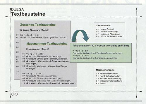
Mit der Software Duega kann der Zustand der Bauteile erfasst werden. Danach lassen sich Sanierungsmassnahmen und -kosten ermitteln. Folge haben kann. Ohne Weiteres denkbarist es etwa, dass das Tiefbauamt Überprüfungen der Abwasserkanalisation vornimmt. Martin Rutz sagt: «Wenn sich herausstellt, dass einige Meter Kanalisationsleitungen instandgesetzt werden müssen, so geht das ins Geld. Die Kosten für die Zuleitung bis zur Hauptleitung auf der öffentlichen Strasse gehen zulasten des Bauherrn.»
