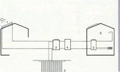
Prinzip der Saisonspeicheranlage mit Kollektoren und einem oberflächennahen Erdspeicher.
