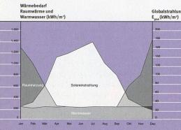
Zeitlicher Verlauf von Solarstrahlungsangebot und Gesamtwärmebedarf eines Reihenhauses in Niedrigstenergie-Standard.
