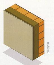
Eine Kompaktfassade üblicher Bauart: Backsteine, Wärmedämmung, Aussenputz. Mit 15 cm Dämmstoff wird ein Achtfamilienhaus zu einem Minergie-Gebäude.
