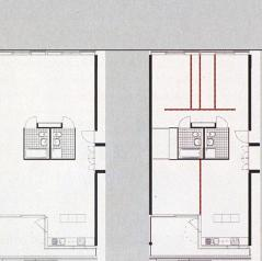
Zwei Betonscheiben und raummittig gesetzte Nasszellen definieren den Spielraum in der Grundrissgestaltung. Zwischen den Tragmauern können Wände (rot markiert) in vielen Variationen gesetzt werden. 18 Grundvarianten von der 1- bis zur 6-Zimmer-Wohnung wurden nach diesem Konzept entwickelt und gebaut.
