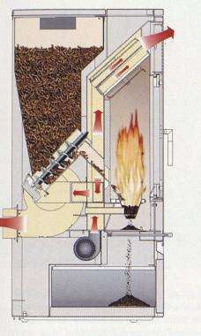
Pelletfeuerungen schneiden bei der Ökobilanz gut ab. Hier eine Anlage mit integriertem Pelletbehälter.
