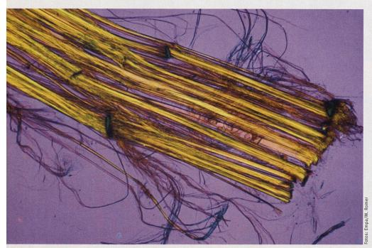
Chrysotil, der häufigste Asbesttyp, im Polarisationslichtmikroskop. Ersichtlich sind die feinsten, flexiblen Faserbüschel und Fibrillen.
