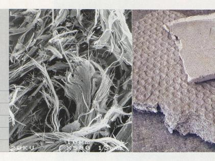
Fest gebundener Asbest ist nur gefährlich, wenn er mechanisch beschädigt ist, und auch dann setzt er nur wenige Fasern frei. Ist er intakt, muss man ihn nicht vorzeitig entfernen. Bei Sanierungen sollte man darauf achten, dass er möglichst nicht zerstört und nicht in Schuttmulden geworfen wird.
