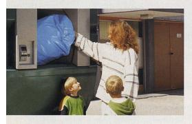
Presscontainer mit Zugangskontrolle und geeichter Wiegeeinrichtung erlauben eine Gebührenverrechnung über das Gewicht. Der Zugang erfolgt über eine Magnetkarte, die für einen bestimmten Nutzer konfiguriert ist. Der Abfall wird im Container automatisch gepresst.
