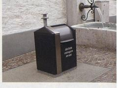
Tiefsammelstelle mit oberirdischen Einwurfsäulen. Der Sammelcontainer befinden sich in einem Betonschacht im Boden.
