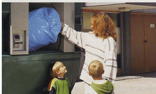
Presscontainer mit Zugangskontrolle und geeichter Wiegeeinrichtung erlauben eine Gebührenverrechnung über das Gewicht. Der Zugang erfolgt über eine Magnetkarte, die für einen bestimmten Nutzer konfiguriert ist. Der Abfall wird im Container automatisch gepresst.
