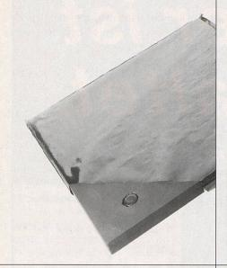
Aufbau eines Vakuum-Dämmpaneels mit einem Kern aus gepresster Kieselsäure. Die Hüllfolie ist fünflagig, um optimale Eigenschaften zu erreichen. Neue Materialien ermöglichen eine drastische Verringerung der Verluste
