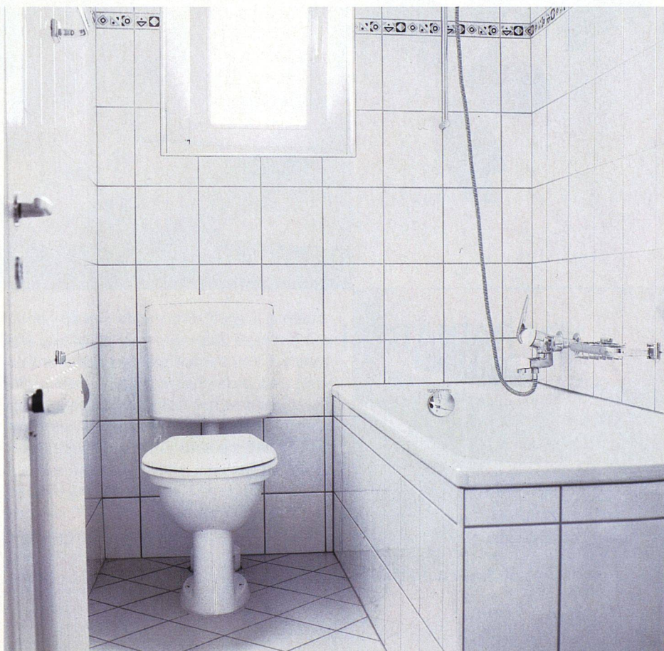
Badzimmersanierung bei der Allgemeinen Baugenossenschaft Aarau (Abau): vorher (oben) und nachher. Da keine Grundrissvergrößerungen möglich waren, musste aus dem bestehenden Raum das Beste gemacht werden. Badewanne, Lavabo, Armaturen und WC wurden ersetzt, helle Plättli reichen neu bis zur Decke, für die Boiler konnten andere Standorte gefunden werden.
