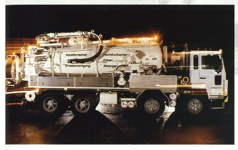
Mit solchen Kombi-Fahrzeugen werden Leitungen gespült und Schlamm abgesaugt.
