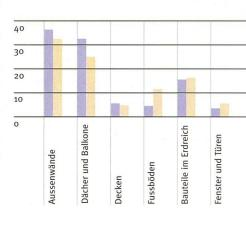
Die bisherigen Untersuchungen zeigen, dass ein grosser Teil von vermeidbaren Bauschäden auch bei Sanierungen und Instandsetzungen auftreten. Lesebeispiel: Rund 37% aller Schäden bei Instandsetzungsund Modernisierungsarbeiten werden bei Aussenwänden festgestellt, etwa 33% bei Dächern und Balkonen (Quelle: Dritter Bericht über Schäden an Gebäuden).
