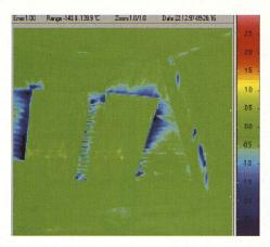
Infrarot-Subtraktion in einem Dachraum
