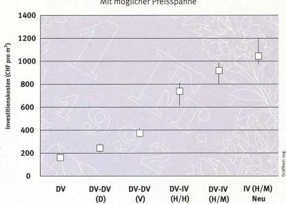
Die Abbildung (rechts) widerspiegelt die Investitionskosten (Verglasung, Dichtung, Oberflächenbehandlung) mit Streuungsbereich des Altfensters, der vier Sanierungs- und einer Ersatzvariante. Die Kosten gelten für Fenster mit durchschnittlichen Massen und ohne Sprossen. Bei allen sind die Anstrichskosten enthalten. Beim Neufenster sind auch die Kosten für die Demontage des alten Fensters eingerechnet.
