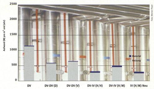
Die Grafik zeigt den Primärenergiebedarf des Altfensters, der vier Sanierungsvarianten und einer Neufenstervariante. Dargestellt ist der Primärenergieaufwand für die Heizung und für die Bereitstellung der notwendigen Materialien (Baustoffe, Unterhalt, Rückbau).
