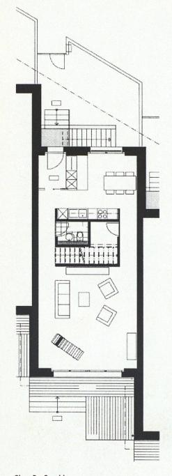
Oben: Der Grundriss orientiert sich an der Mitte des Hauses – dort sind zentral Küche, Bad, Medien und Erschliessung untergebracht.
