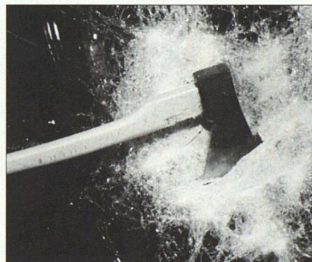
miteinander verbunden sind, haben eine einbruchhemmende Wirkung. Bei Schlägen oder Stößen geht das Glas nicht kaputt. Bei Verbundssicherheitsglas kann das Glas brechen, aber die Bruchstücke bleiben an der Folie haften und es entsteht eine sogenannte Bruchspinne.
