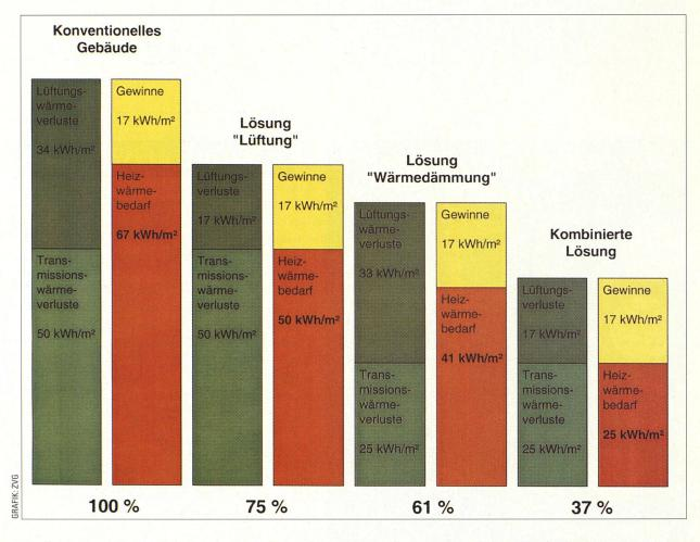
Der Einbau einer Lüftungsanlage kann durchaus mit einer Aussendämmung konkurrenzieren, insbesondere bei einem beschränkten Sanierungsbudget. Die Grafik zeigt aber, dass die Dämmung als Baumassnahme energetisch mehr bringt, allerdings auch unter höheren Kostenfolgen (Gerüstkosten!).
