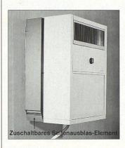
Auch die «intelligente» Steuerung ist eine Neuheit von Roth-Kippe. Der Wäschetrockner wird mit dem Timer eingeschaltet. Die Steuerung übernimmt jetzt ein Thermostat, der bei genügend trockener Luft die Entfeuchtungseinheit und das Heizelement ausschaltet. Die Luft wird durch den laufenden Ventilator weiter umgewälzt. Hat die Raumluft wieder Feuchtigkeit aufgenommen, schaltet der Hygrostat Entfeuchtung und Heizung wieder ein.
