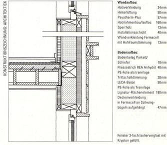
Fassadenschnitt einer Holzkonstruktion
