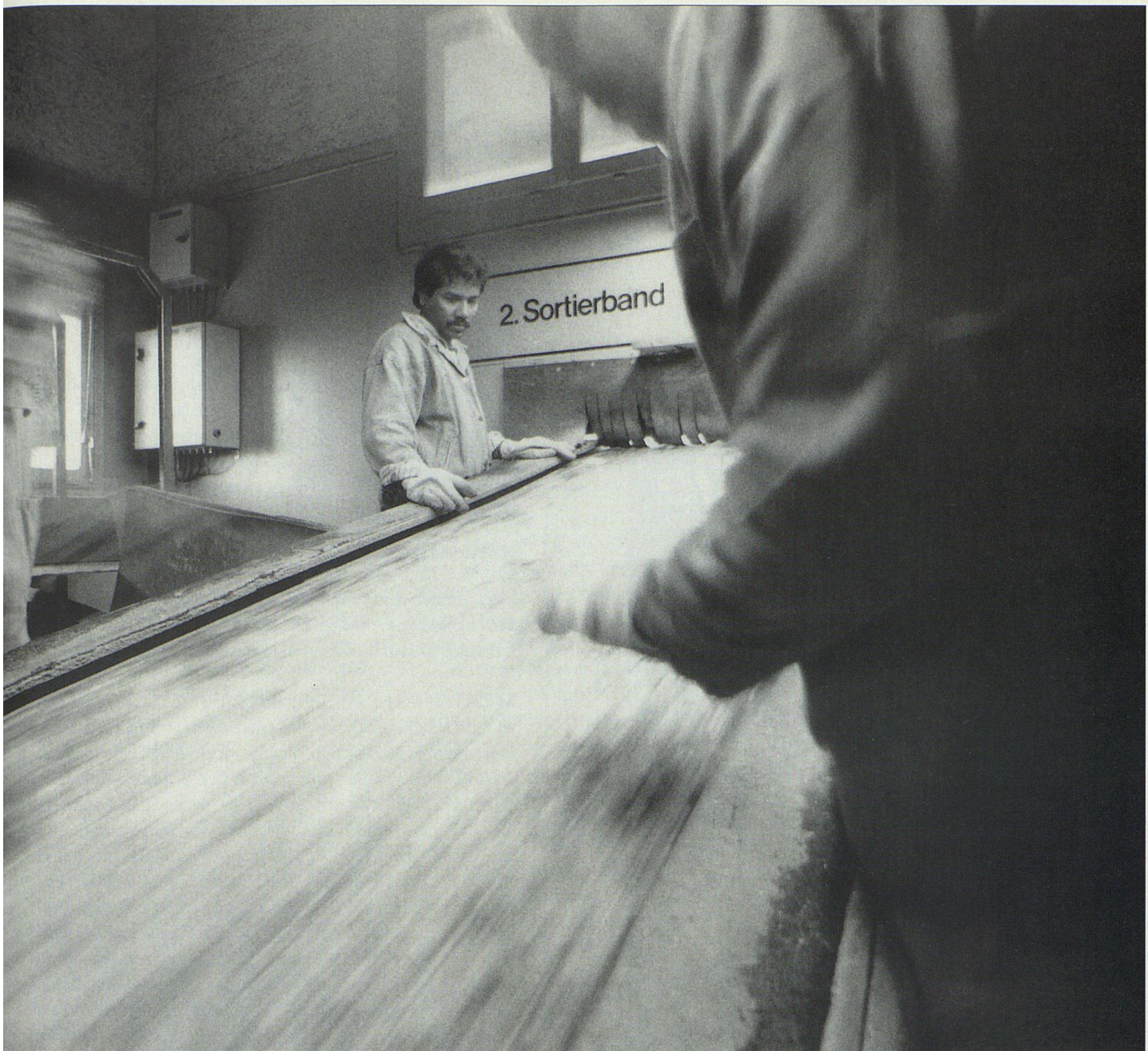
Jährlich geben Schweizerinnen und Schweizer über 230 000 Tonnen Altglas in den Kreislauf der Glasaufbereitung. Im 2-Schicht-Betrieb wird das Bruchglas von Fremdstoffen wie Kleidern, Regenschirmen, Ölfaschen und Keramikteilen getrennt.
