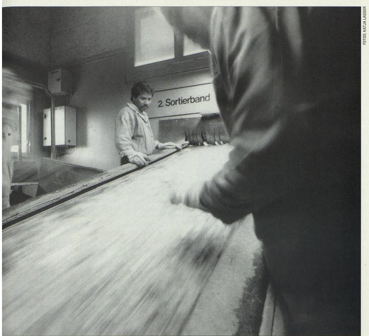
Jährlich geben Schweizerinnen und Schweizer über 230 000 Tonnen Altglas in den Kreislauf der Glasaufbereitung. Im 2-Schicht-Betrieb wird das Bruchglas von Fremdstoffen wie Kleidern, Regenschrimen, Öflaschen und Keramikteilen getrennt.
