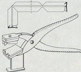
Die HEBGO-Ausklinkzange für Falzdichtungen ist im Fachhandel erhältlich.
