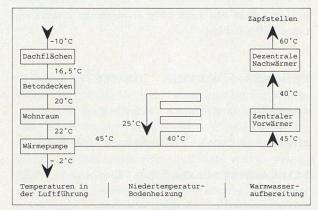
Temperaturverhältnisse in der Luftführung, im Heizsystem und in der Warmwasseraufbereitung an einem kalten Wintertag ( $-10 \,^{\circ}$  C).
